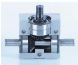
**Typ LMA** – Das Leichtbau-Kegelradgetriebe im Alu-Gehäuse mit 1:1 Übersetzung und Drehmomenten bis 40Nm. Optimal im Einsatz für Handverstellungen oder für Kraftumlenkungen mit geringer Leistungsanforderung.
